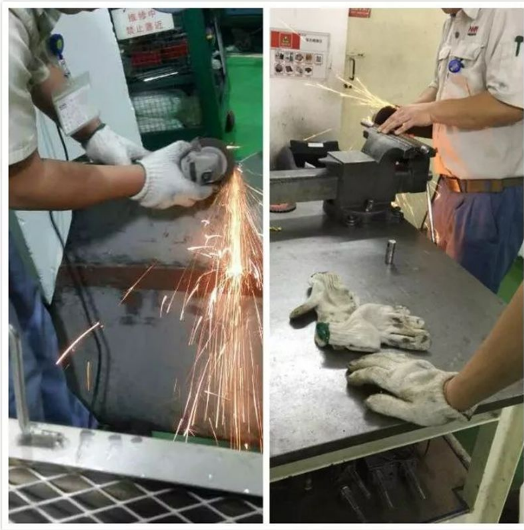
Arbeiten ohne Schutzkleidung
